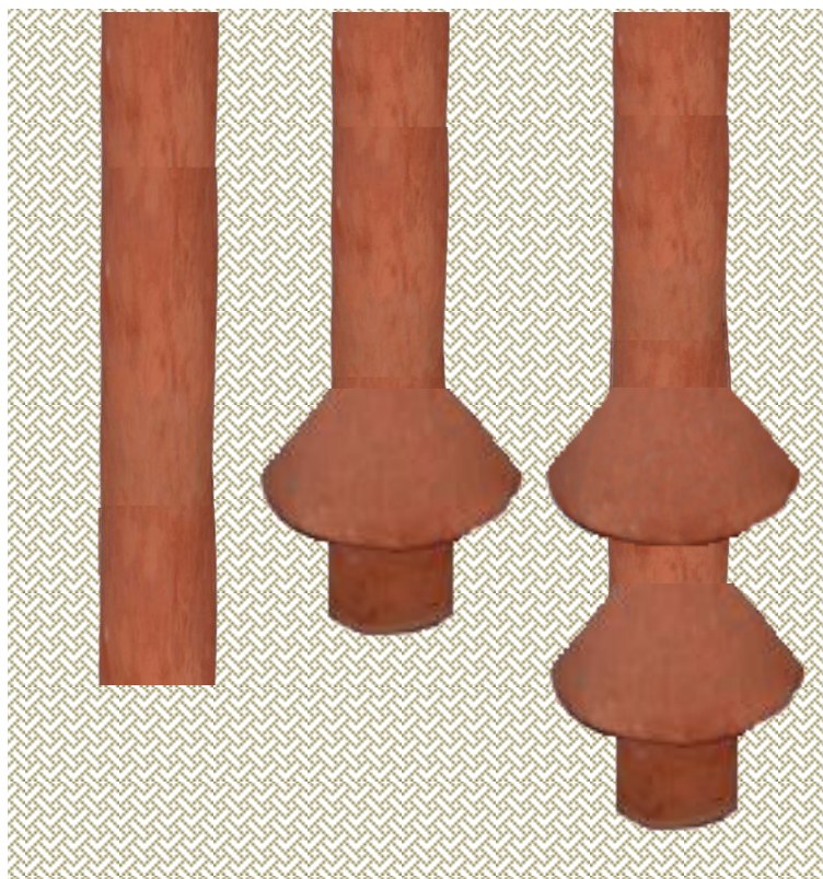
Figura 3.10 Forma final das estacas de Solo Cimento
