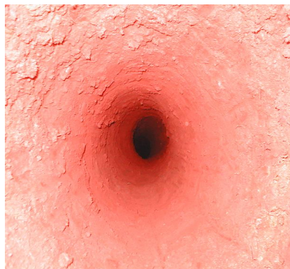
Foto 3.7 Aspecto do furo escavado mecanicamente
