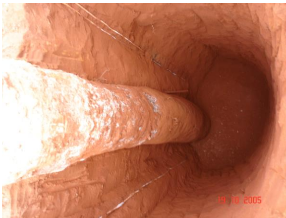
Foto 3.18 Estaca de SCP exumada, mostrando os medidores de umidade
