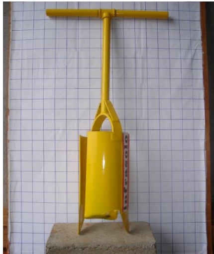
Foto 3.5 Trado manual desenvolvido por Fundex/Infrasolo (2006) e caçamba alargadora de base, desenvolvida por Berberian (1967)
